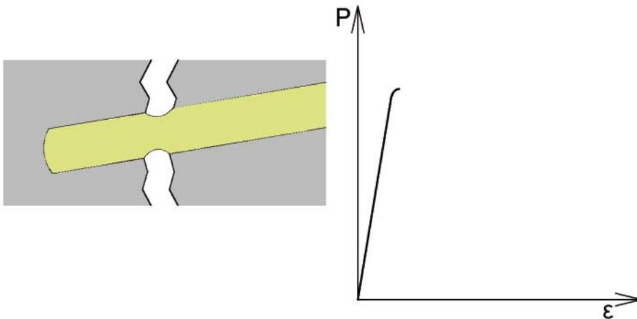
**Phase 2** ist gekennzeichnet durch den fortschreitenden Ablösevorgang der Faser von der umgebenden Zementsteinmatrix. Es ist, wenn man so will, die Phase des Verbundversagens. Die von der Faser aufgenommene Kraft erleidet einen plötzlichen mehr oder minder steilen Abfall. Je länger die Faser, umso länger dauert die Phase 2 des Ablösens.
