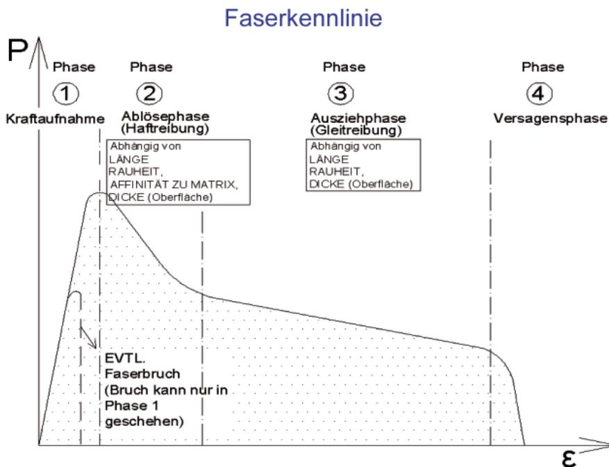
Die Faserkennlinie erlaubt es uns, Schlüsse für die Auswahl von Fasertypen für verschiedene Einsatzzwecke zu ziehen.
