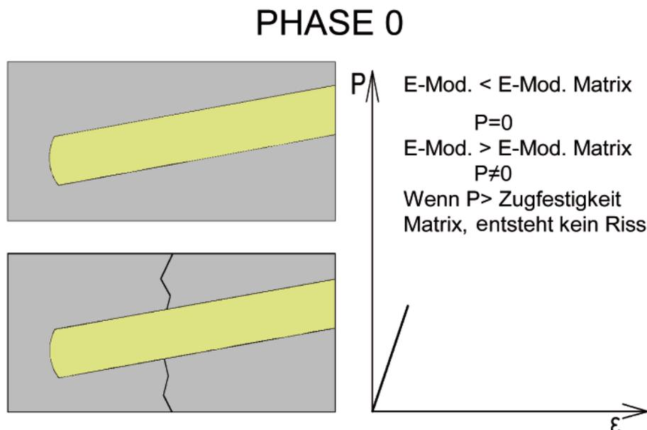
**Phase 1** beschreibt das Verhalten der Einzelfaser während einer mechanischen Belastung des Betons durch Zugkräfte, solange die Faser sich im festen Verbund mit der umgebenden Matrix befindet.
