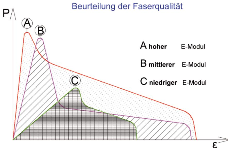
**Kennlinie A** kennzeichnet eine Faser mit hohem E-Modul, bedingt durch den steilen Anstieg der Kraftaufnahme in Phase 1, mit guter Haftung wegen der relativ flachen Abnahme der Kraftlinie, einer kurzen Ablösephase, und eine lange Faser mit hoher Gleitreibung beim Ausziehen resultierend aus der langen und relativ steilen Ausziehphase.
