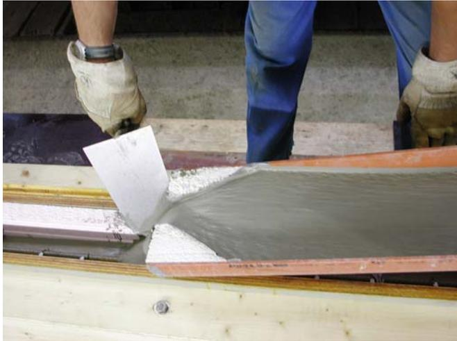
Die Verarbeitung erfolgt bei einem W/B = 0,26 mit 0,2% Hochleistungsverflüssiger, bezogen auf den Bindemittelanteil. Das ergibt ein Fließmaß von 72 cm mit dem Ausbreitmaßtrichter und 82 cm mit dem Slumptrichter (Bild 2).
