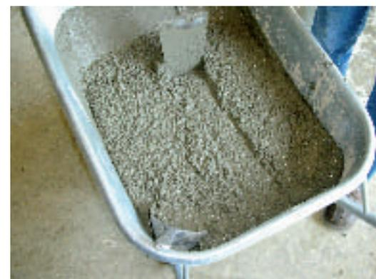
Bild 6: Sehr weiche, entmischungsfreie Betonmatrix
