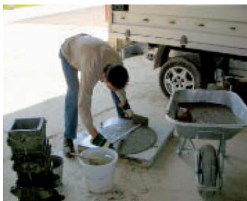
Bild 5: Genaue Messung des Ausbreitmaßes
