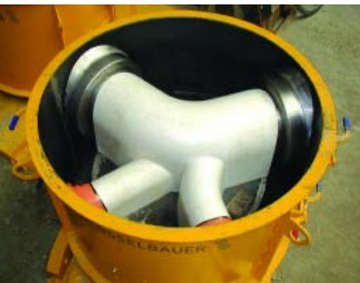
Der vorgefertigte Polystyrol-Teil wird mit den Anschlussmuffenformen in die Gießform eingelegt.
