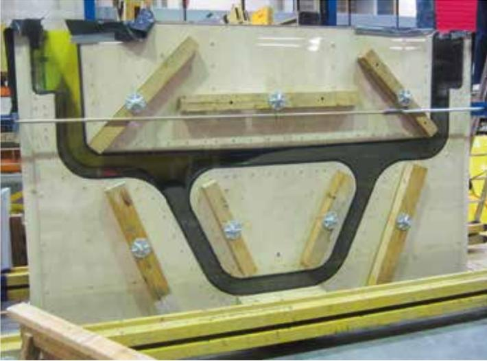
Abbildung 5: Befüllversuch in transparenter Schalung
