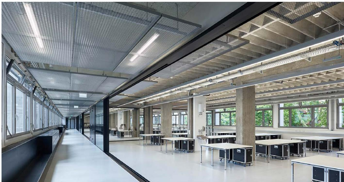
Der sogenannte Schwanzer-Wörle-Trakt der Universität für angewandte Kunst wurde umfassend saniert – sämtliche nicht konstruktiven, nachträglichen An- und Zubauten wurden entfernt. Die Struktur der Betonmittelstützen und die Betonrippendecken aus den 60er Jahren wurden freigelegt. Der architektonisch bedeutende Trakt, die Tragstruktur erinnert an den Industriebau um 1900, wurde zwischen 1961 und 1965 nach dem Entwurf der beiden Architekten Karl Schwanzer und Eugen Wörle errichtet.
