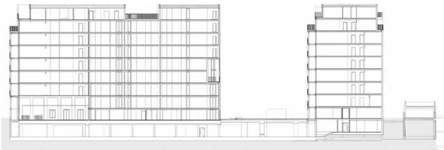
Der Einsatz von Stahlbetonfertigteilen im Projekt erfolgte im Wesentlichen für die gestalterisch sehr hervortretenden Loggienkonstruktionen in Sichtbetonqualität.
