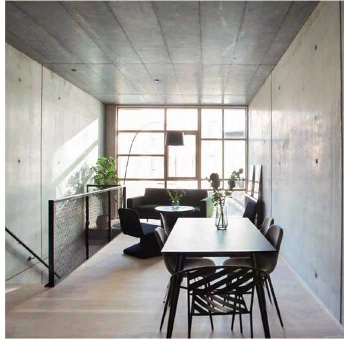
Bei den Upcycle Studios wurden ausschließlich recycelter Beton, wiederverwendete Doppelverglasung und alte Fußbodenbretter verwendet. Das Holz stammt aus der dänischen Manufaktur Dinesen, die sonst einen Teil des Materials entladen und verbrannt hätte, während die Fenster aus alten Gebäuden stammen. 75 Prozent der Fenster stammen aus abgebrochenen Sozialwohnungen in Nordjütland.
