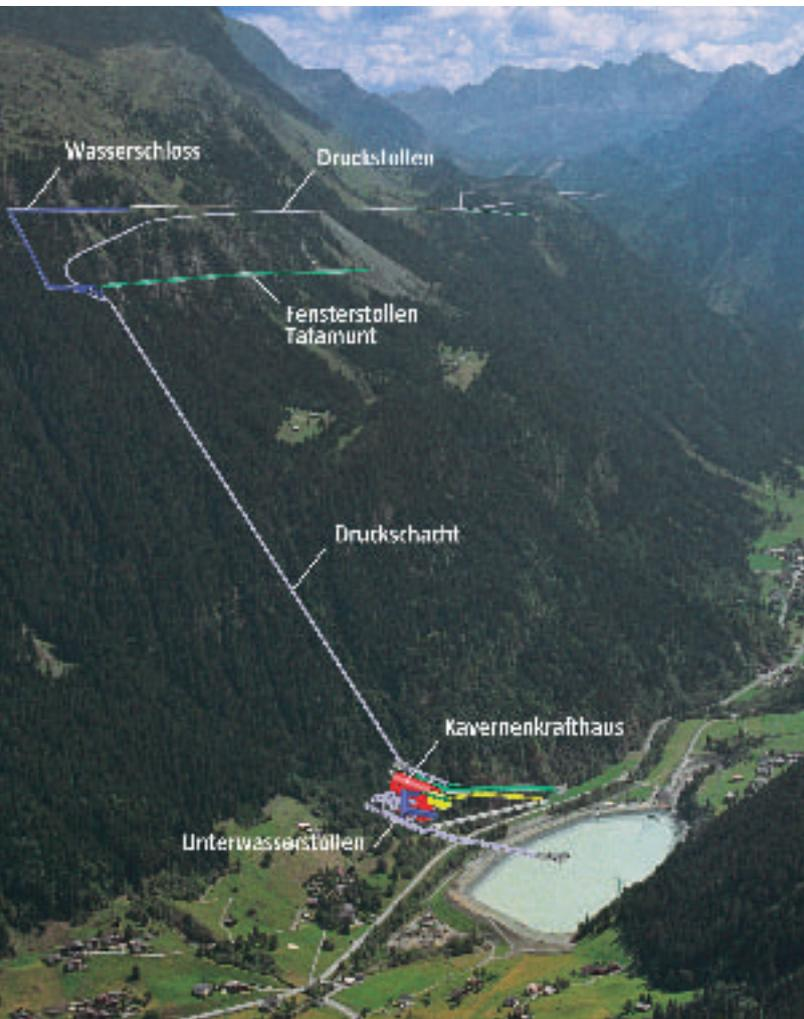
Bild 1: Kopswerk II – Gesamtanlage
