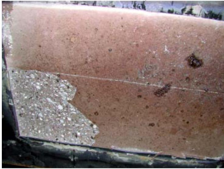
Bild 3: WDI-Beton mit 2 kg/m<sup>3</sup> PP-Fasern nach Brand [1]
