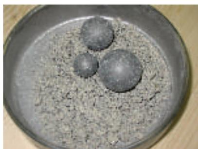
Nicht korrekt zerkleinerte Probe
