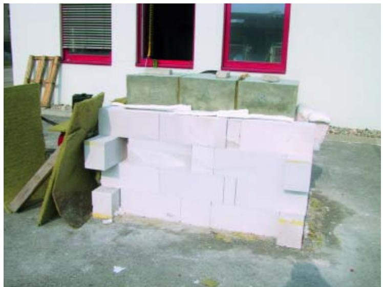
Dem Beton wurden  $2 \text{ kg/m}^3$  PP-Fasern beigegeben. Die Überprüfung der Faserverteilung nach zwei unterschiedlichen Verfahren zeigte eine gute und homogene Verteilung der Fasern im Beton [4; 5].
