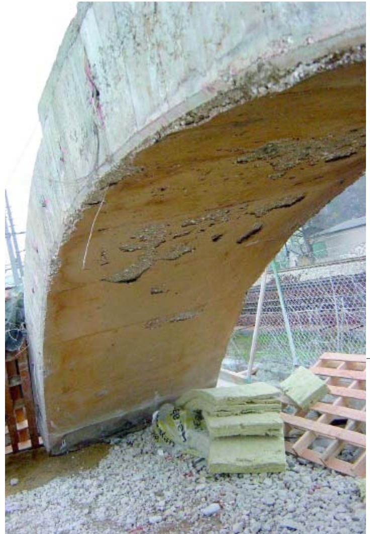
Abb. 9: Großbrandversuch LT 22: die Kalotte nach dem Abkühlen mit deutlich erkennbarer Schädigung, hervorgerufen durch das Abfallen der thermisch zerstörten Oberfläche. Foto: © Dr. Horvath
