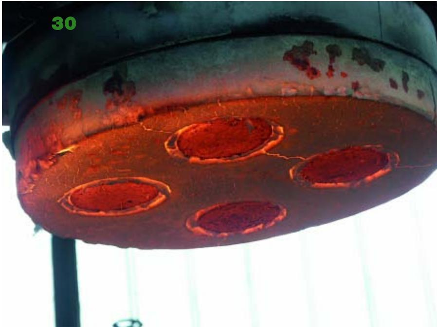
Abb. 3: Deckel des ARP-Versuchsofens unmittelbar nach Beendigung eines Kleinbrandversuches mit vier zylindrischen Prüfkörpern. Durchmesser der Prüfkörper = 150 mm Foto: © ARP
