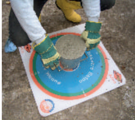
Abb. 4.2: Hochziehen des befüllten Trichters
