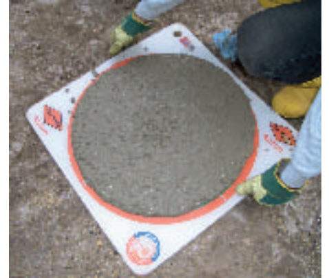
Abb. 4.3: Messung des Ziehmaßes
