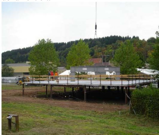
Abb. 9 Versuchsdecke mit Rahmen für Hydraulik
