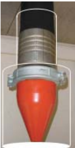
Bild 3: Die Kombination Schlauch-Kupplung-Bremskonus unter dem Schutzmantel
