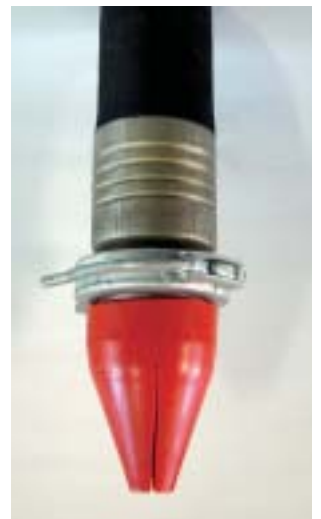
Bild 2: Die „neue Betonbremse“, hier noch ohne Schutzmantel Alle Fotos: Fa. R. Kanhäuser
