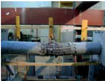
Bild 6: Bruchbild der Stütze B1 mit einer Querbewehrung von ø 6/4 cm.
