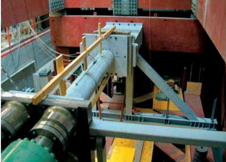
Bild 2: Ansicht vom Versuchsaufbau mit Hydraulikzylindern im Vordergrund, Druckplatte, Versuchskörper, Druckplatte mit Linienkipplager, Widerlagerbock und Distanzmodulen.
