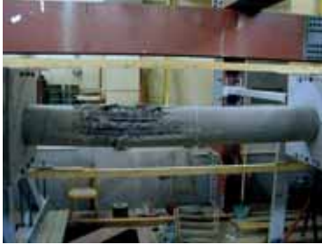
Bild 5: Bruchbild der Stütze A3 mit einer Querbewehrung von ø 6/10 cm.
