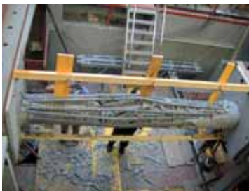
Bild 7: Bruchbild der Stütze C1 mit einer Querbewehrung von ø 6/20 cm.
