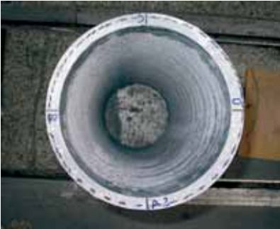
Abb. 2: ED-Stab mit CFK-Schlauch
