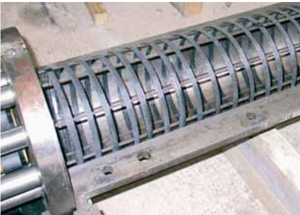
Abb. 5: CFK-Wendel, CFK-Drähte für D-Stab
