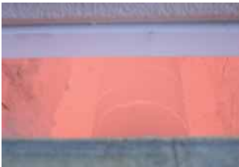
Abb. 5: Stütze unmittelbar nach Brandversuch
