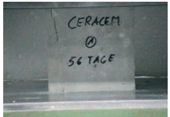
Abb. 1: Druckprüfung eines Probewürfels ohne Fasern nach 56 Tagen
