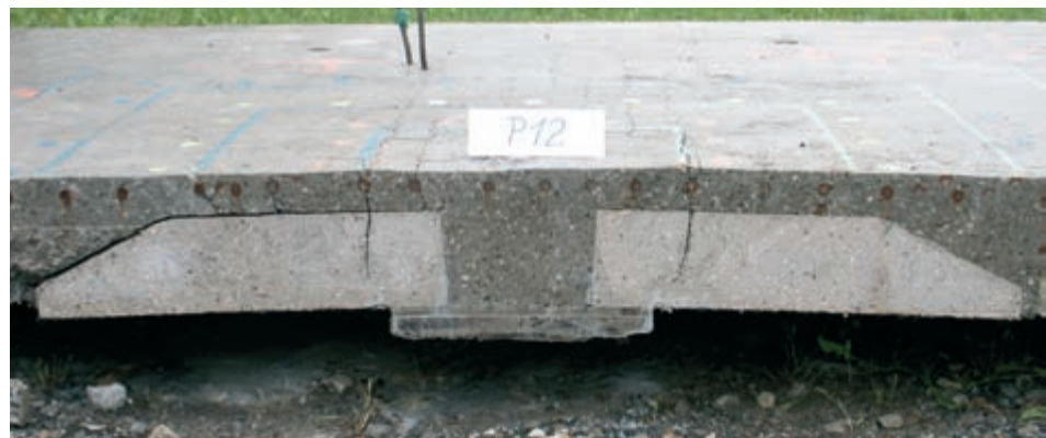
Abb. 11: Aufgeschnittener Versuchskörper mit einem großen UHPC-Pilz. Der Versuch wurde bei einer Stützenverformung von 80 mm abgebrochen. Fotos: © Sika Österreich GmbH
