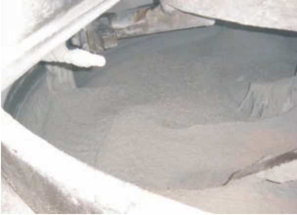
Abb. 4: Mischen des UHPC
