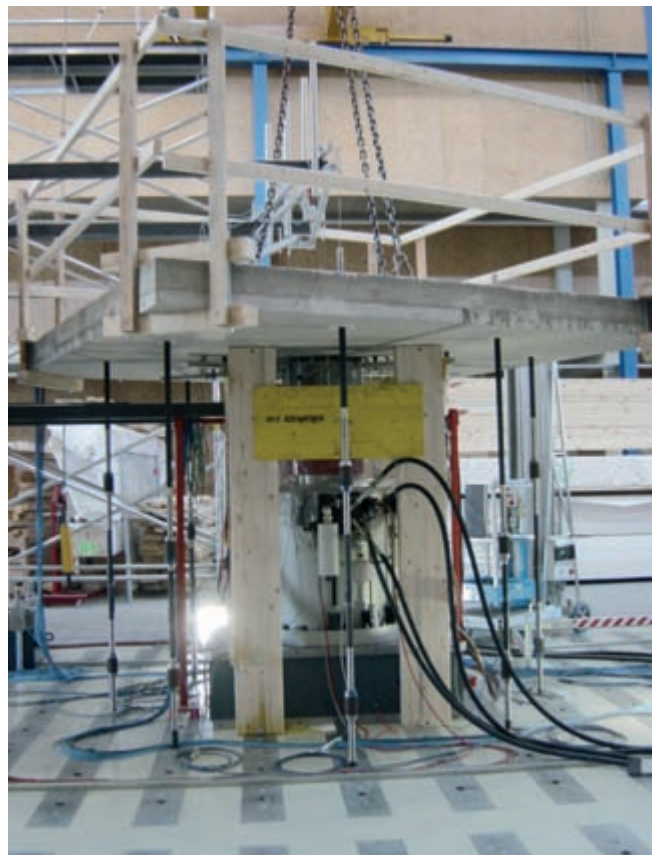
Abb. 9: Versuchsaufbau mit mittig situierter Presse und den 8 Zugstangen
