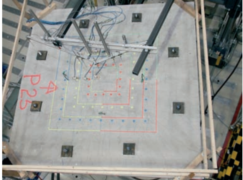
Abb. 8: Draufsicht auf eine Versuchsplatte. Zu sehen sind die Messeinrichtungen der Plattenoberseite und die symmetrisch angeordneten Zugstangen mit den Verankerungsplatten. Die farbige Markierung dient der Orientierung, der Linienabstand beträgt 25 cm.
