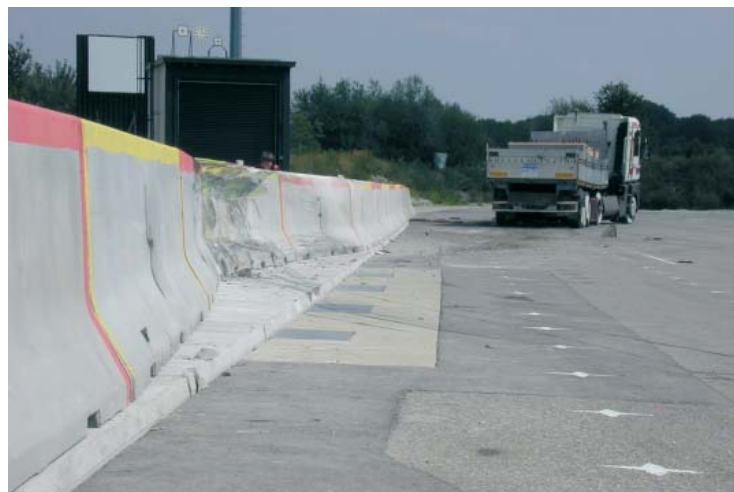
H2/TB51-Prüfung mit 16-t-Bus an Delta Bloc® 80AS-R und H4b/TB81-Prüfung mit 38-t-Sattelzug an Delta Bloc® 100AS-R
