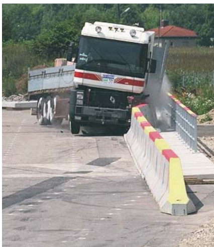
H2/TB51-Prüfung mit 16-t-Bus an Delta Bloc® 80AS-R und H4b/TB81-Prüfung mit 38-t-Sattelzug an Delta Bloc® 100AS-R
