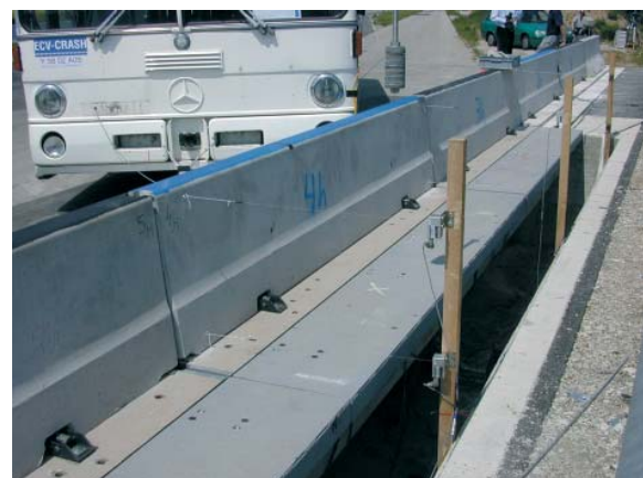
Versuchsanordnung Delta Bloc® 80AS-Br, H2-System mit Schienenverankerung
