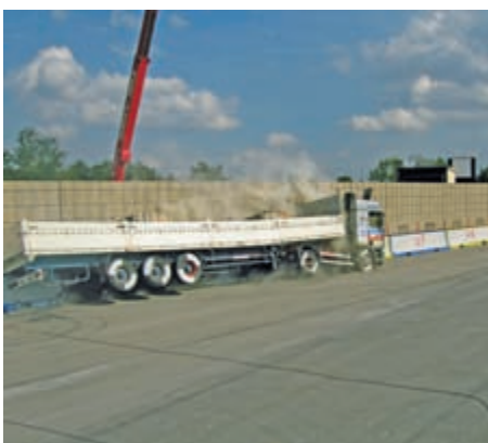
Anprall-TB81-Prüfung an DB LSW 400-M
