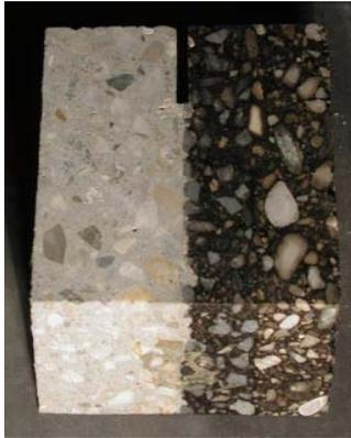
Abbildung 7: Farbunterschied in der Matrix von Beton und Asphalt [Foto VÖZFI]
