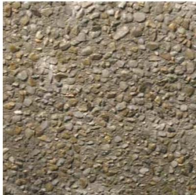
Abbildung 8: Waschbetonoberfläche mit heller Gesteinskörnung [Foto VÖZFI]
