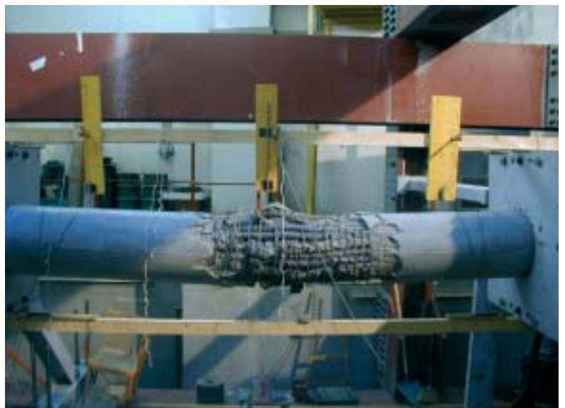
Abbildung 2a: zerstörte Stütze nach dem Versuch
