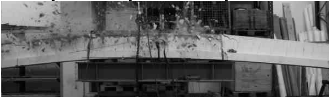
Abb. 3: Großversuch, Abplatzen der Betondeckung bei eingeschlizten Lamellen ohne Vorspannung.
