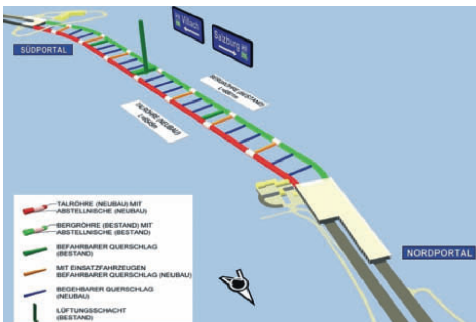
Schemata Tunnelanlage Tauerntunnel
