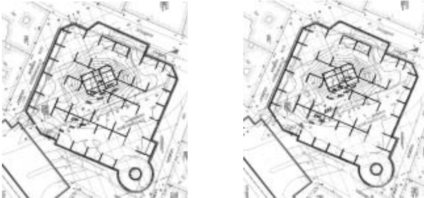
Verteilung der Bodenpressungen vor und nach der Aufstockung. Charakteristisch ist die Setzungsmulde unter dem zentrisch angeordneten Kern zu erkennen.
