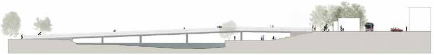
finden bereits im Herstellungsprozess Anwendung. So können durch den Wegfall der mechanischen Lager- und Übergangsbau- teile sowie den Vorspannungsverzicht einerseits wesentliche Materialkosten eingespart werden. Außerdem kann der Bauablauf wesentlich vereinfacht und beschleunigt werden.
