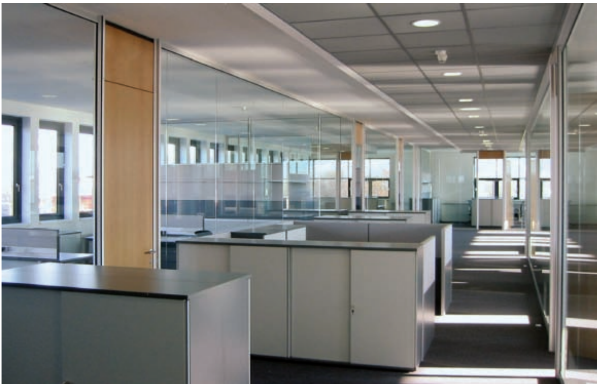
Innenansicht des Büroregelgeschosses mit Systemtrennwänden und Kopierinseln
