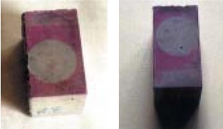
Bild 2: Bestrahlte Proben aus selbstverdichtendem und hochfestem Beton
