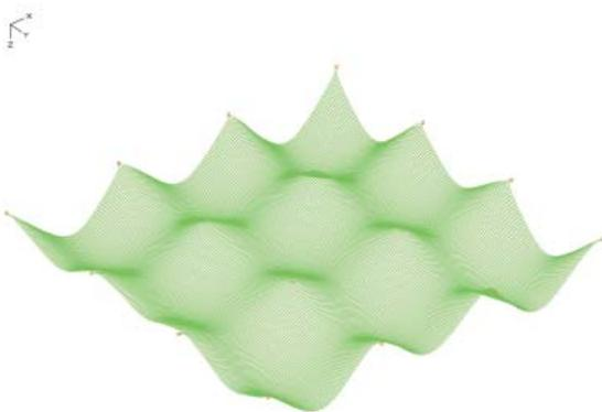
Abb. 4: Verformungen zufolge Vorspannung und Dauerlast
