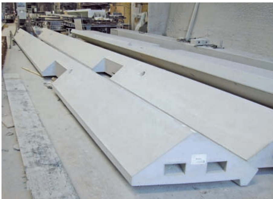
Abb. 5: Lagerung Fertigteilprofilstufen (Osttribüne)
