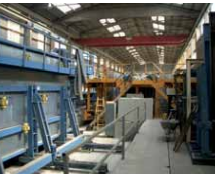
Abb. 1b: Variable Raumzellenschalungen
