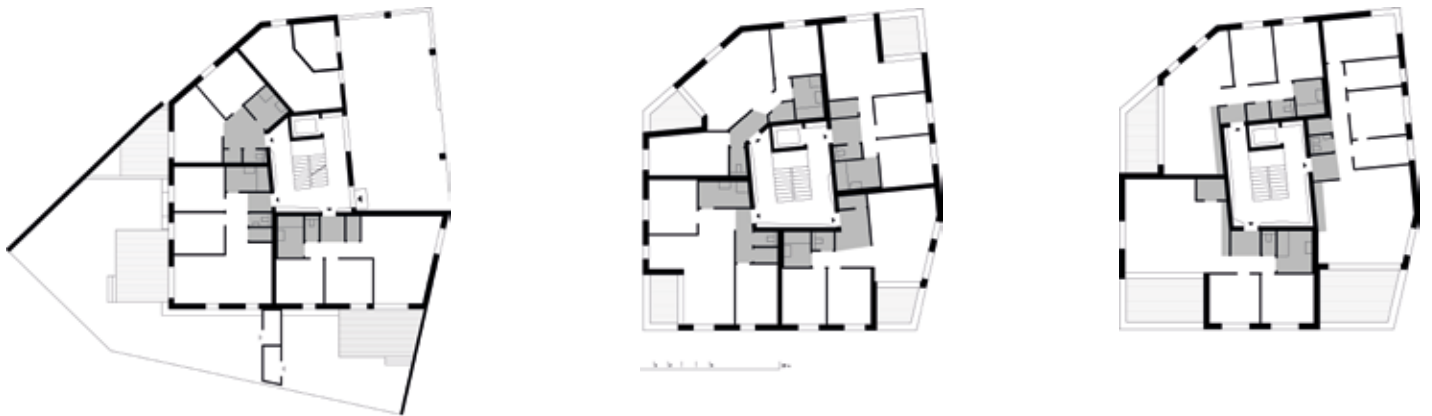
Grundrisse Haus B: Erdgeschoß, 1. Obergeschoß, Dachgeschoß
