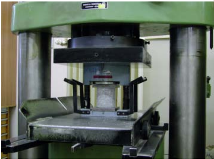
Bild 3: Untersuchung der Ist-Druckfestigkeit zum Nachweis der Standsicherheit Fotos: © VÖZFI
