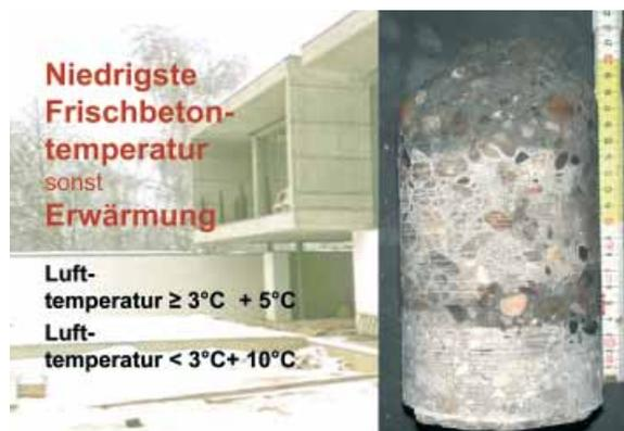
Aus diesem Grund fordert die Norm bei Lufttemperaturen über  $3^{\circ}\text{C}$  eine Betontemperatur von mindestens  $5^{\circ}\text{C}$  und bei tieferen Lufttemperaturen von mindestens  $10^{\circ}\text{C}$ . Nur bei Einhaltung dieser Forderung und der notwendigen sonstigen Winterbaumaßnahmen sind die in der Norm festgelegten Nachbehandlungsfristen ausreichend und am Ende der Nachbehandlung die Gefrierbeständigkeit gegeben.
