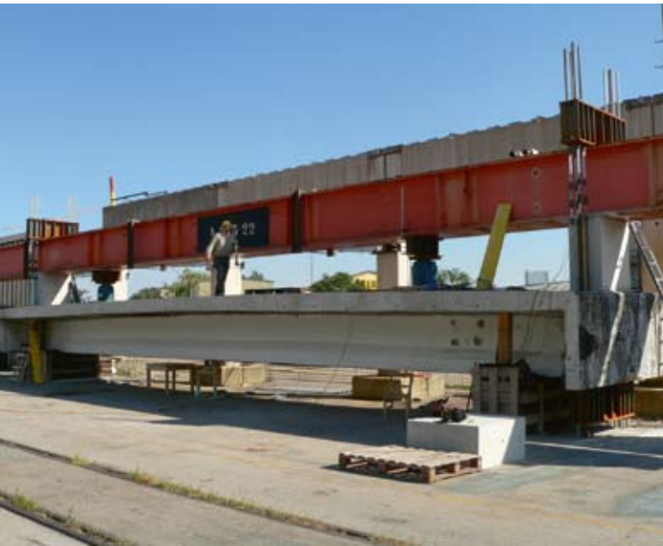
Versuchsaufbau mit Hilfsbrücken-Stahlträgern IPE 1000
