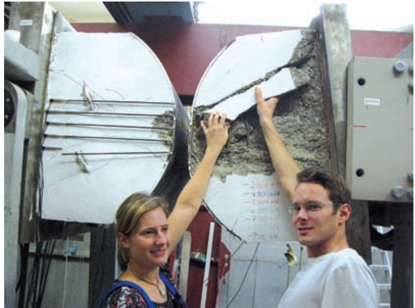
Abb. 2: Wälzgelenke mit Radius 0,5 m, Stahlblechdicke 10 mm, nach dem Belasten bei Laststufe 9.000 kN
