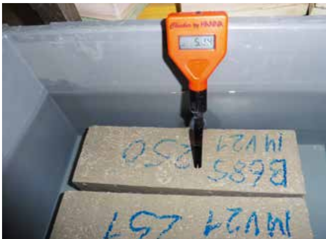
Abbildung 1: Lagerung von Betonprobekörpern in konzentrierter Essigsäure entsprechend der Expositionsklasse XA2L (pH-Werte-Bereich 4,5–5,4 gemäß [1])
