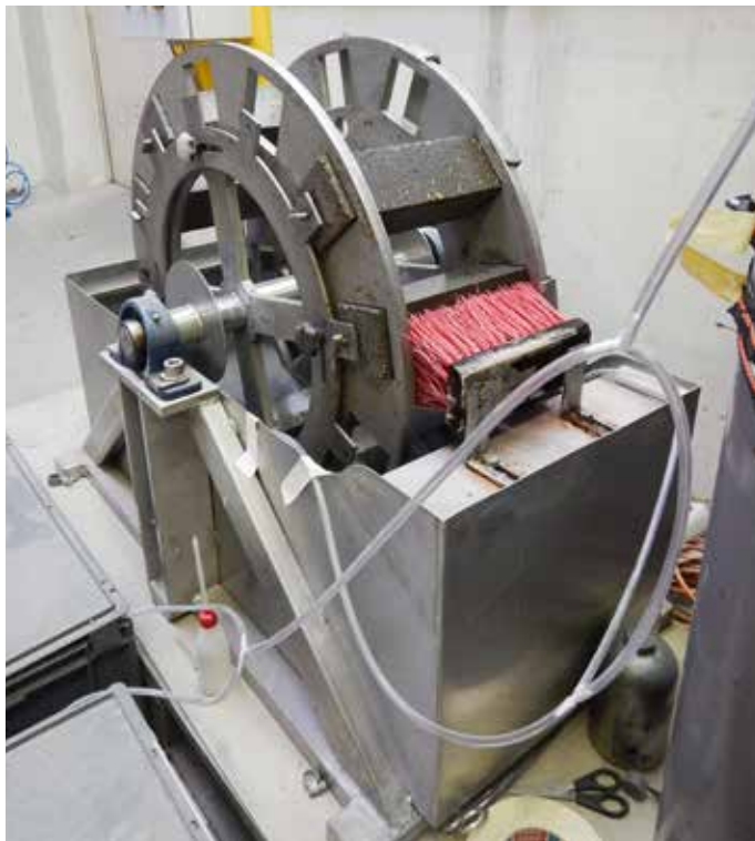
Abbildung 2: Automatisch kontrollierte Belastungseinheit zur Simulation eines lösenden Angriffs unter Berücksichtigung einer Strömungsgeschwindigkeit des angreifenden Mediums sowie zusätzlicher mechanischer Belastung der Betonoberfläche. Herstellung von kalkaggressiver Kohlensäure durch Kohlendioxid einleitende Schläuche in das Prüfbecken
