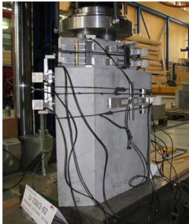
Abbildung 3 Versuchsaufbau einer Gruppenverankerung von Spannlitzen
