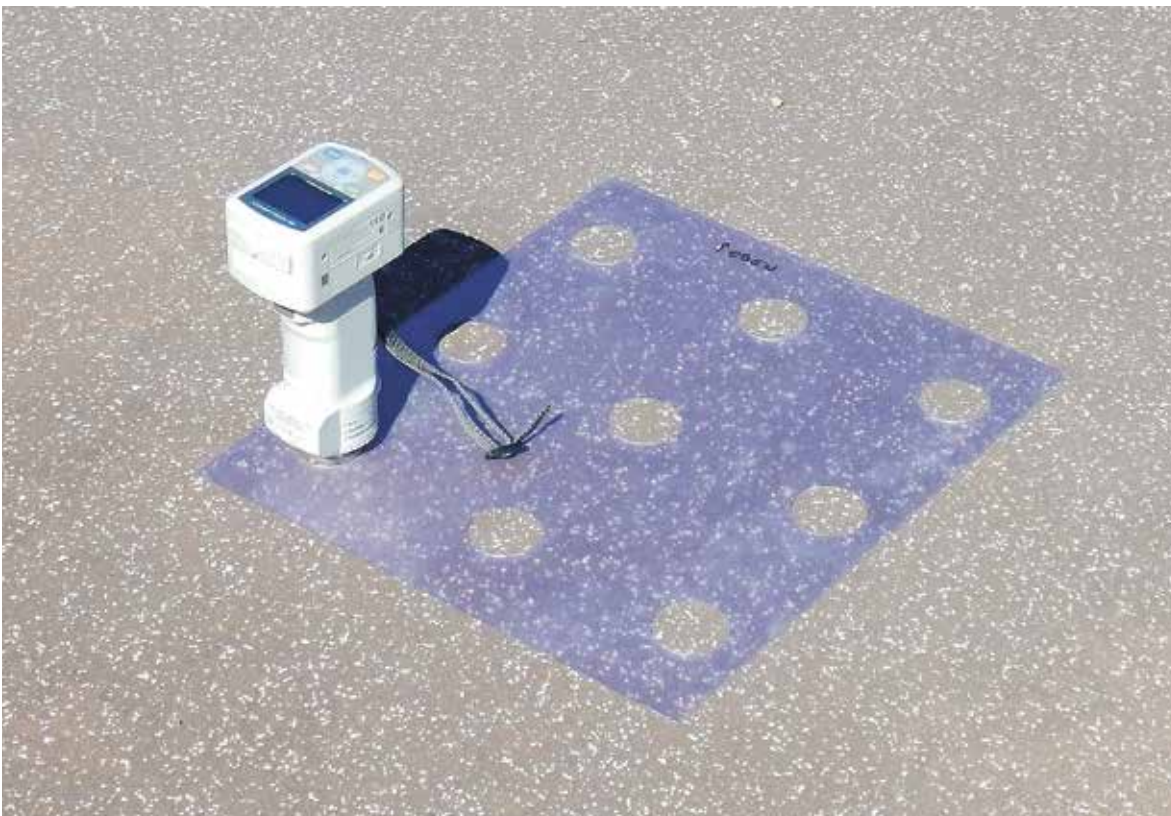
Abbildung 10: Messanordnung zur Ermittlung des Reflexionsgrades
