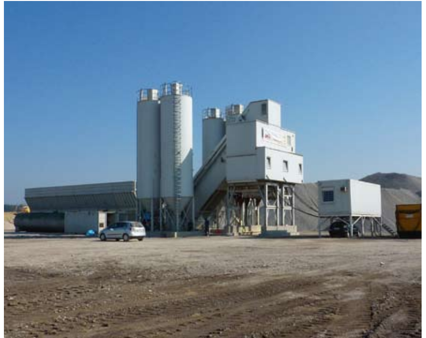
Kaiser Mischanlage mit 2 x 3 m 3 Mixchern
