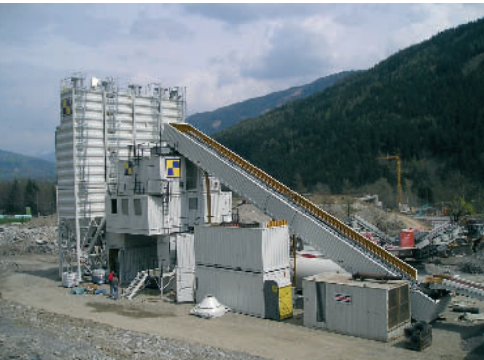
Abb. 1: Mobile Betonmischanlage vor Ort errichtet
