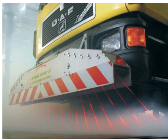
Abb. 3: Fächerförmige Anordnung der Querschnittsensoren. Angegebene Abmessungen in mm
