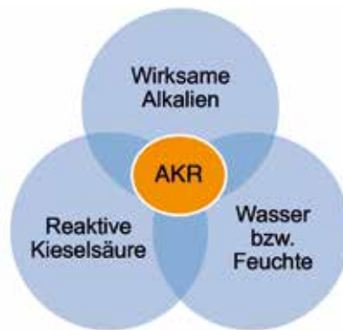
Bild 1 – Zusammenspiel der Ausgangsfaktoren einer Alkali-Kieselsäure-Reaktion
