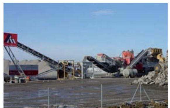
Bild 3: Aufbereitungsanlage von Straßenaufbruchmaterial
