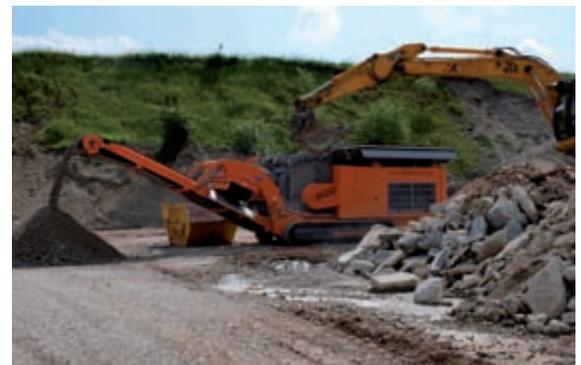
Bild 2: Aufbereitung von Recyclingmaterial aus Betonstraßendecken
