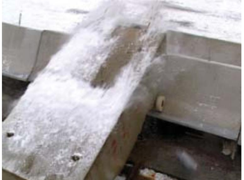
Abb. 5: Anprall des Stahlbetonwagens auf die Betonleitwand
