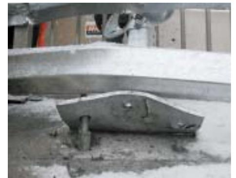
Der Anprallversuch für das Stahlleitschiensystem beim TÜV bei München ergab für die Verankerung eine max. Zugkraft von 169 kN. Somit liegt diese Kraft geringfügig unter den hier festgestellten Werten (ca. 170–180 kN).
