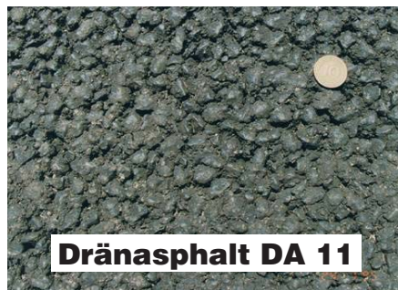
Abb. 4: Bewährte Asphalte für Fahrbahndeckschichten (Beispiele, Fotos ISTU)
