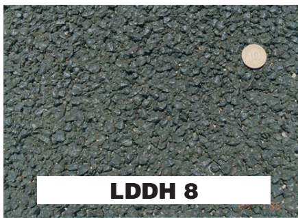
Abb. 4: Bewährte Asphalte für Fahrbahndeckschichten (Beispiele, Fotos ISTU)
