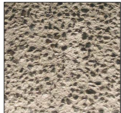
Bild 3: Dunkle Gesteinskörnung mit Titandioxid
