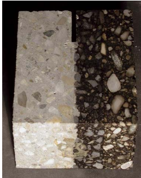
Abbildung 7: Farbunterschied in der Matrix von Beton und Asphalt [Foto VÖZFI]
