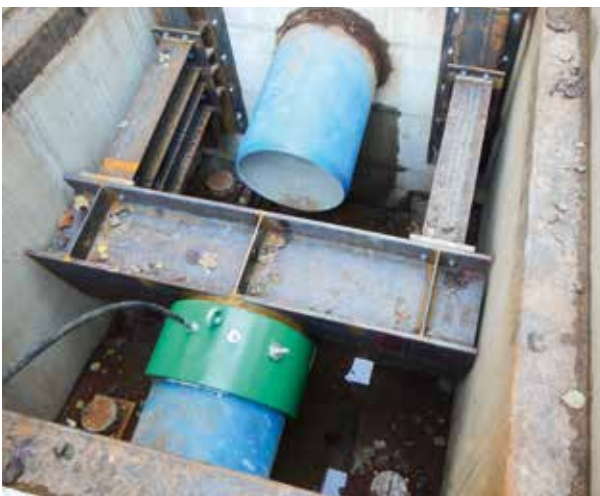
Druckprobe: Deckeldruck 230 t
